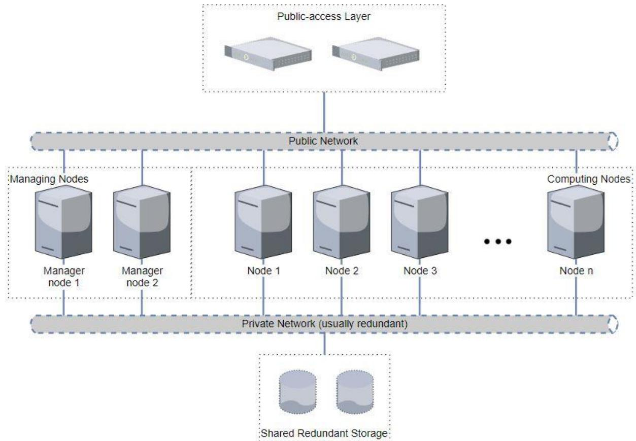
Slika 3.1. Shematski prikaz osnovne arhitekture računalnog klastera<sup>1</sup>
