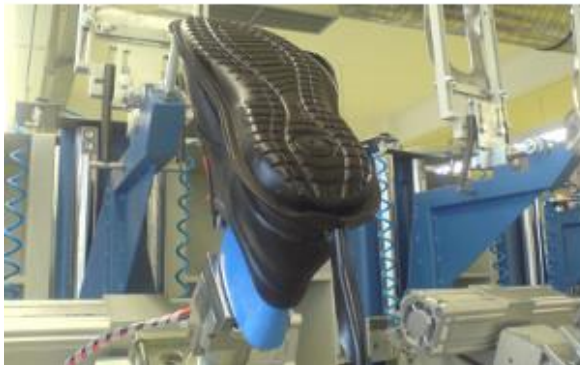
Slika 3.25. Prikaz rada stroja za brizganje poliuretana [2]
