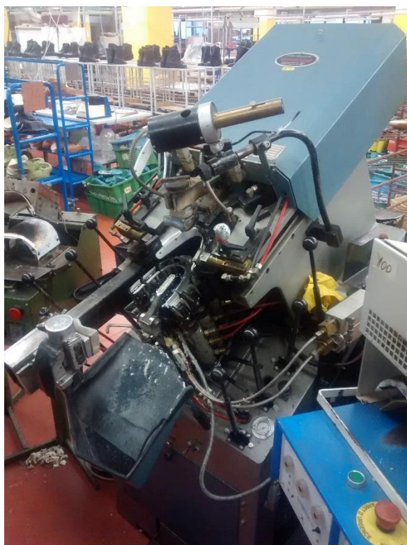
Slika 3.15. Stroj za navlačenje vrha lijepljenjem, International SH-LTF [2]
