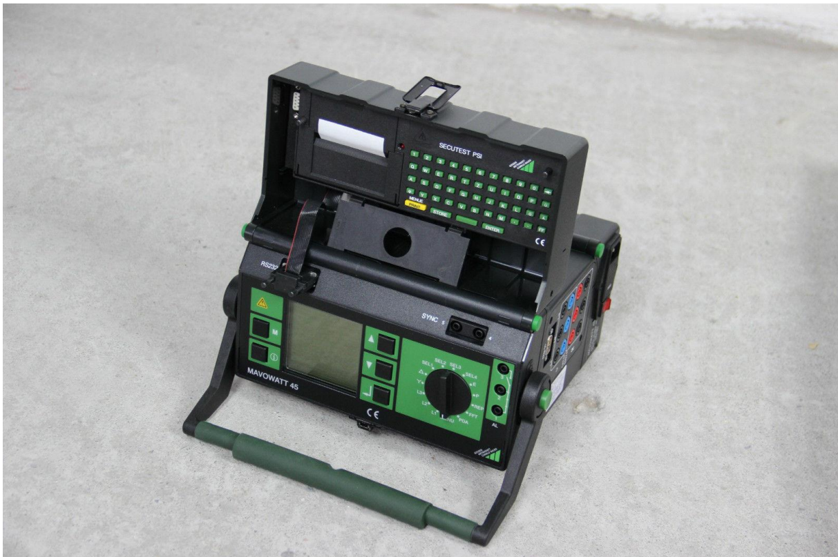
Slika 4.6. Mjerni uređaj – PQ analizator Mavowatt 45 [5]
