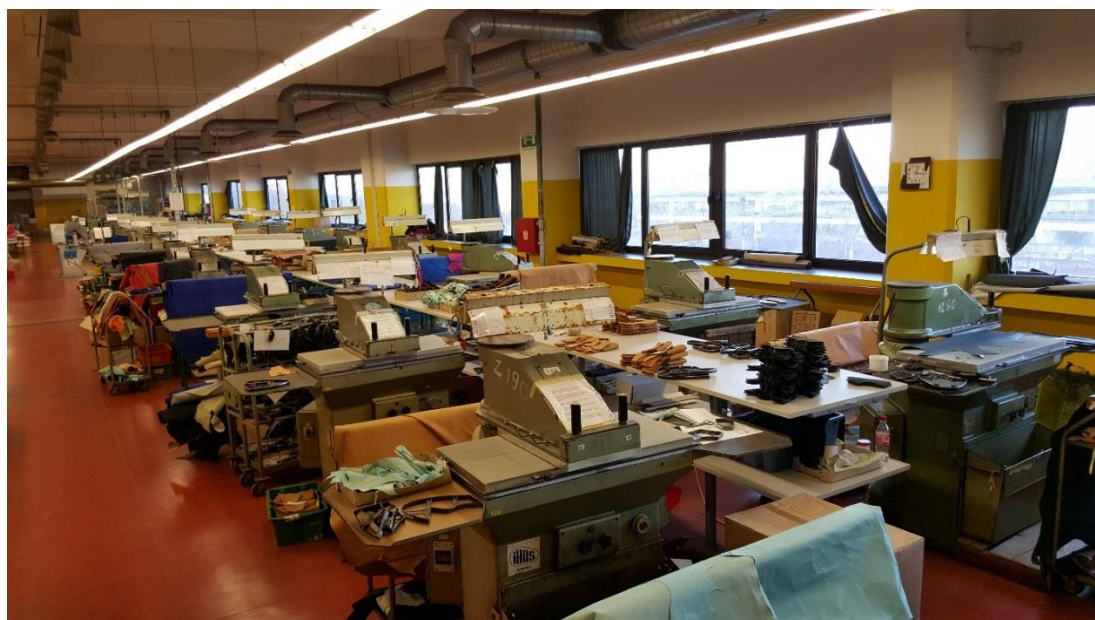
Slika 3.5. Radionica faze isjecanja s hidrauličnim sjekačkim strojevima IKOS 208/6 Kranj [2]
