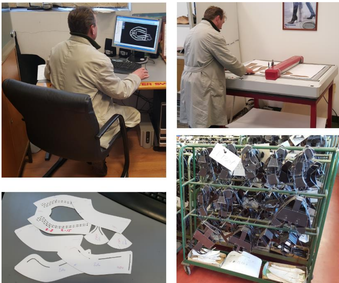
Slika 3.6. Proces dizajniranja, isjecanja šablona na sjekaču WILD TA-30 te gotovi noževi [2]
