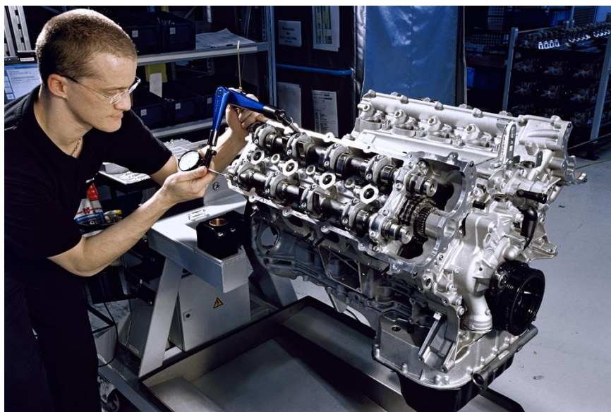
Slika 1.2. 6.3-litreni V8 ICE proizvođača AMG [3]
