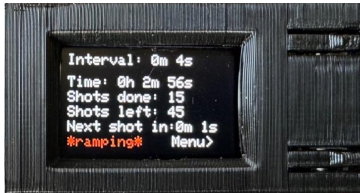
Slika 5.11. Izvođenje time-lapse -a uz ramping intervala
