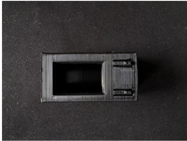
Slika 4.7. Kućište intervalne kamere
