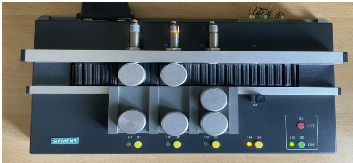
Slika 4.9. Pokretna traka –Status alarm H4
