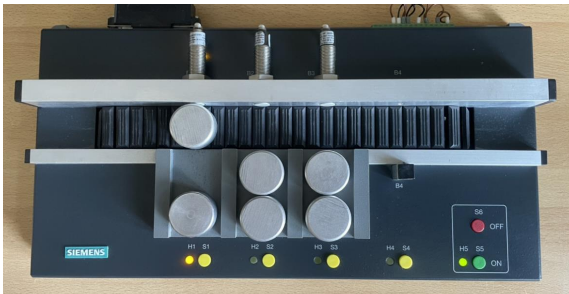
Slika 4.3. Pokretna traka – Status montažno mjesto H1
