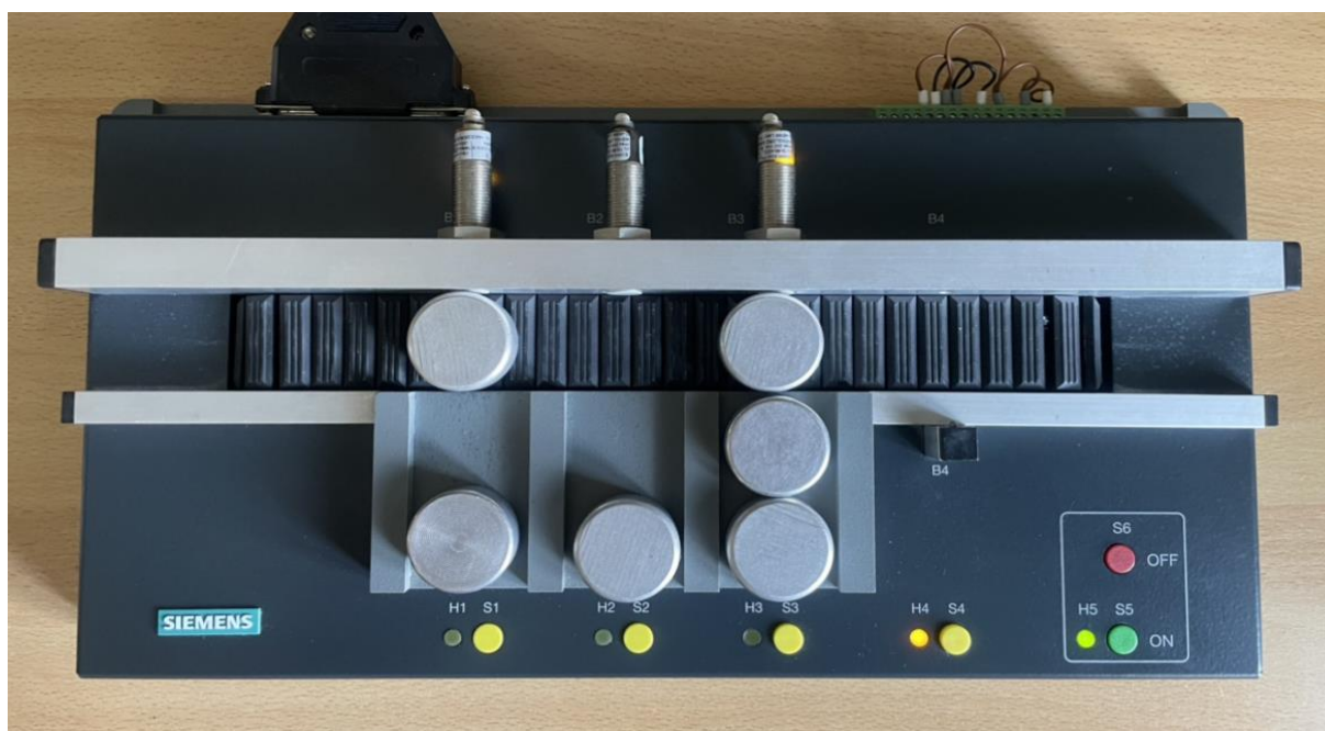
Slika 4.11 Pokretna traka – Status alarm H4
