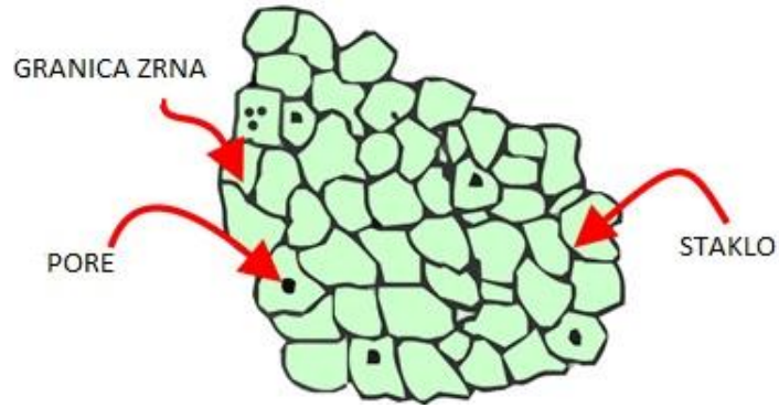
Sl. 3.2. Mikrostruktura keramike
