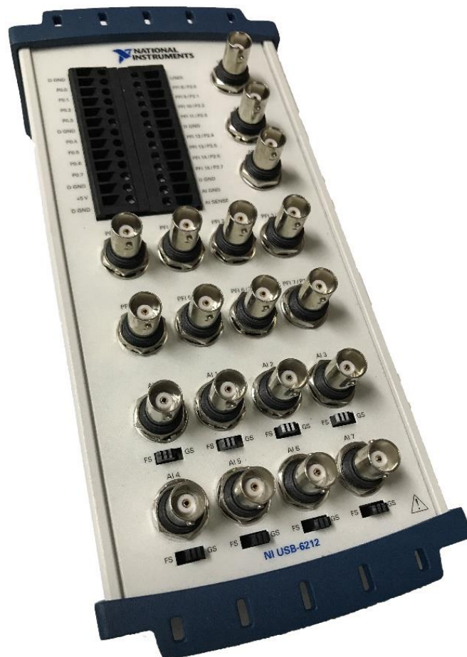
Slika 2.6. Multifunkcijska akvizicijska (DAQ) kartica National Instruments NI-USB 6212.
