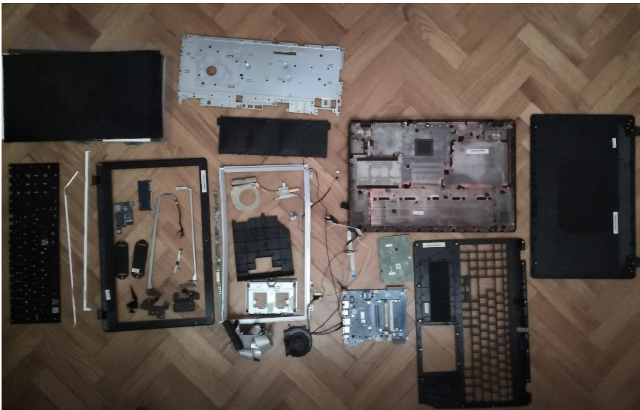
Slika 3.2. Prijenosno računalo Acer N15W4 rastavljeno u dijelove
