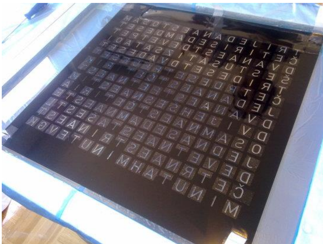
Slika 3.24: Lijepljenje folije na staklo [9]
