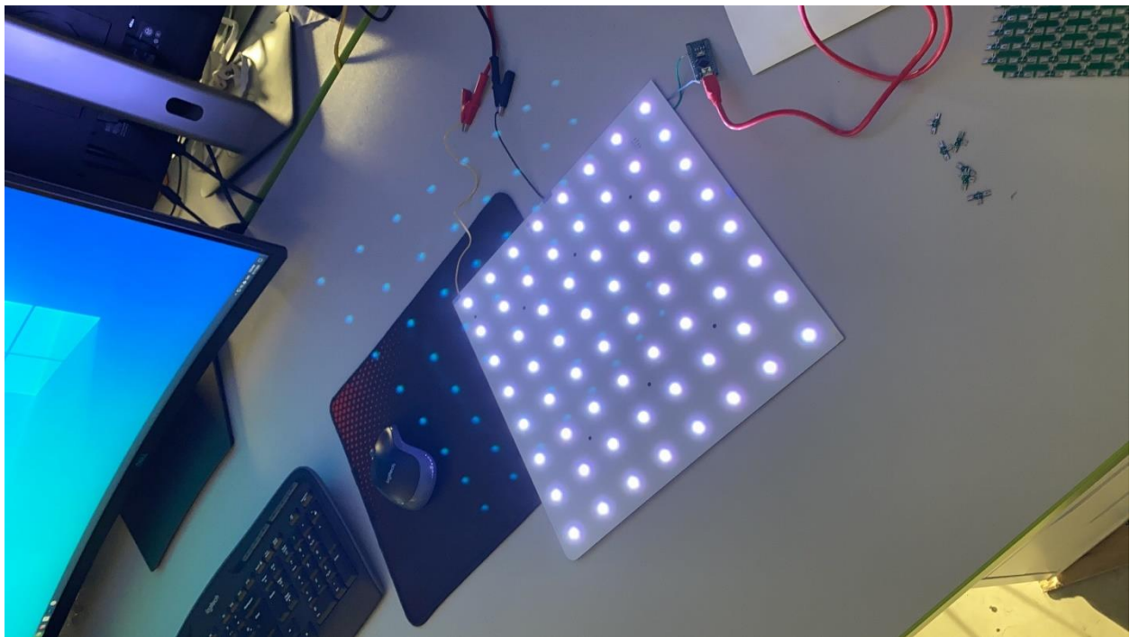
Slika 3.26: Testiranje zasebnog LED panela
