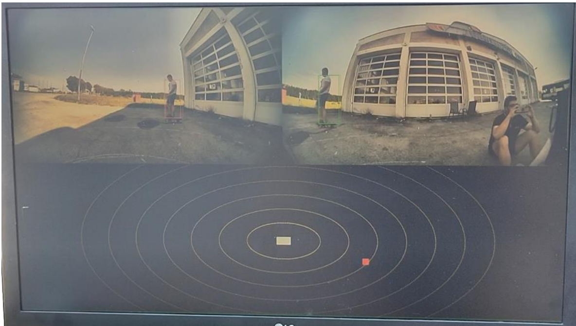
Sl. 3.16. Prikaz na ekranu dobiven kad se pokrene slučaj upotrebe iscrtavanja 2D mape položaja pješaka u okolini vozila koristeći 2 kamere u vozilu
