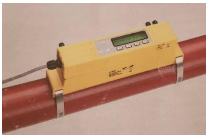
Slika 5.2. Ultrazvučni mjerač Micronics U1000-HM.
