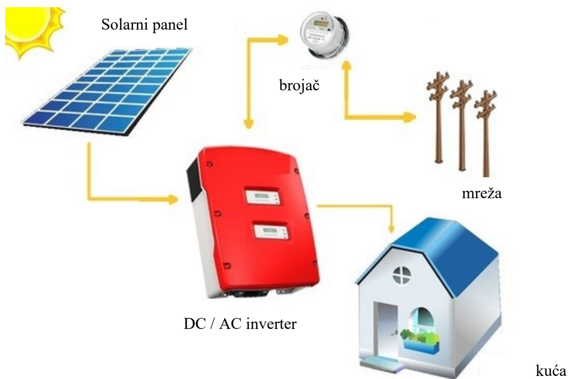
Slika 4.8. On grid solarni sustav [11]
