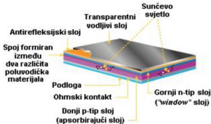
Slika 4.4. Struktura polikristalne tankoslojne FN ćelije [5]
