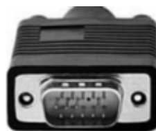
Slika 2.2 : „Muški“ VGA priključak.
