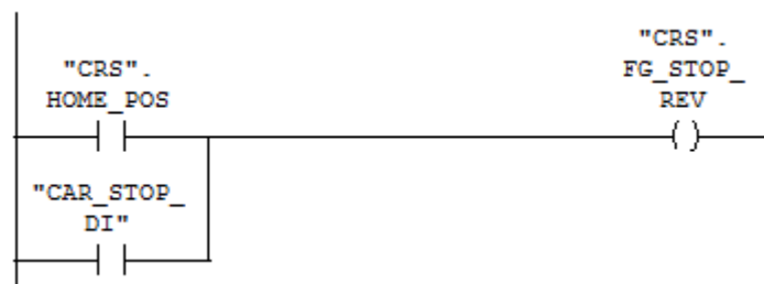
Slika 5.17 Prekid bitovne zastavice za kretanje unatrag
