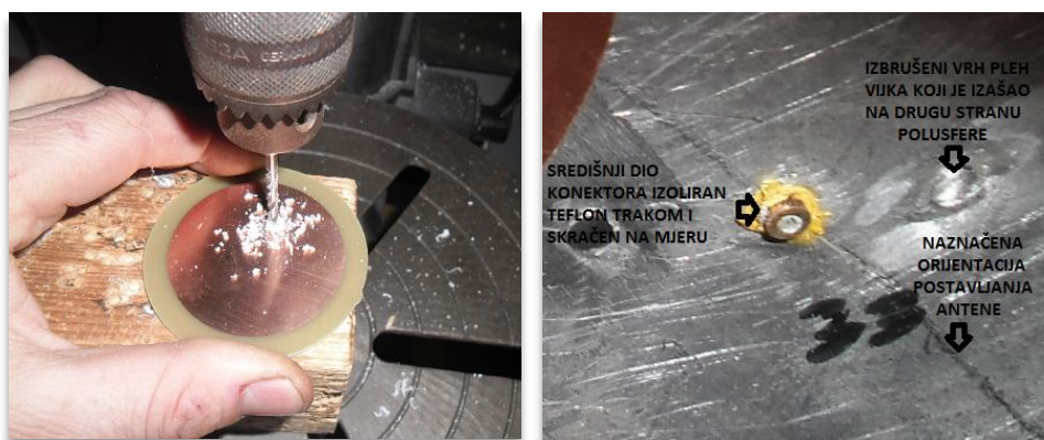
Slika 3.4 a) postupak bušenja provrta, b) pričvršćen N konektor na metalnu polu sferi.
