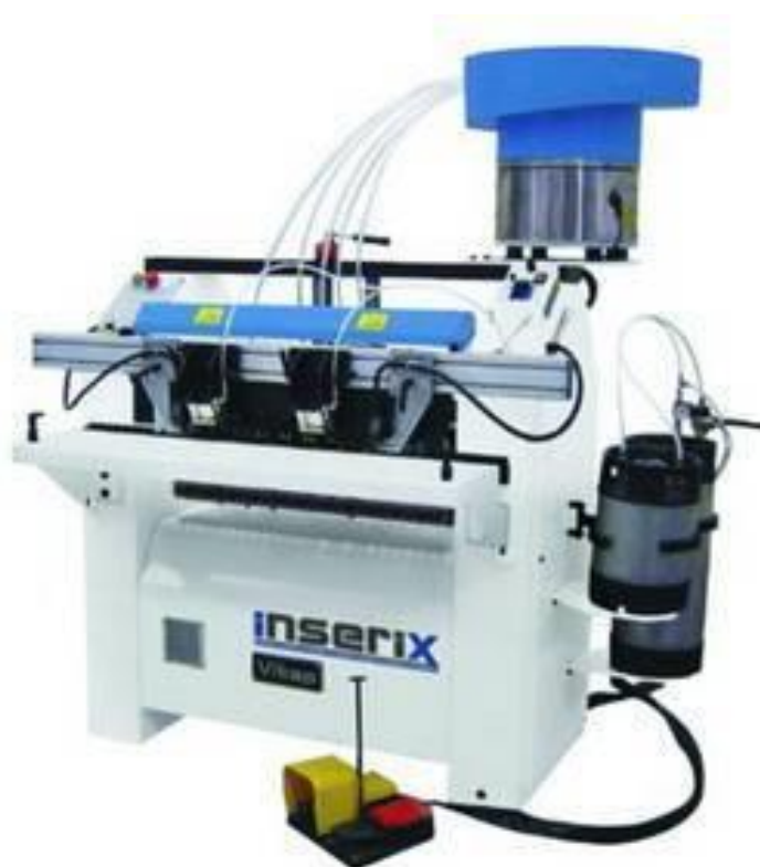
Sl. 4.11. CNC bušilica INSERTIX proizvođača Vitap.
