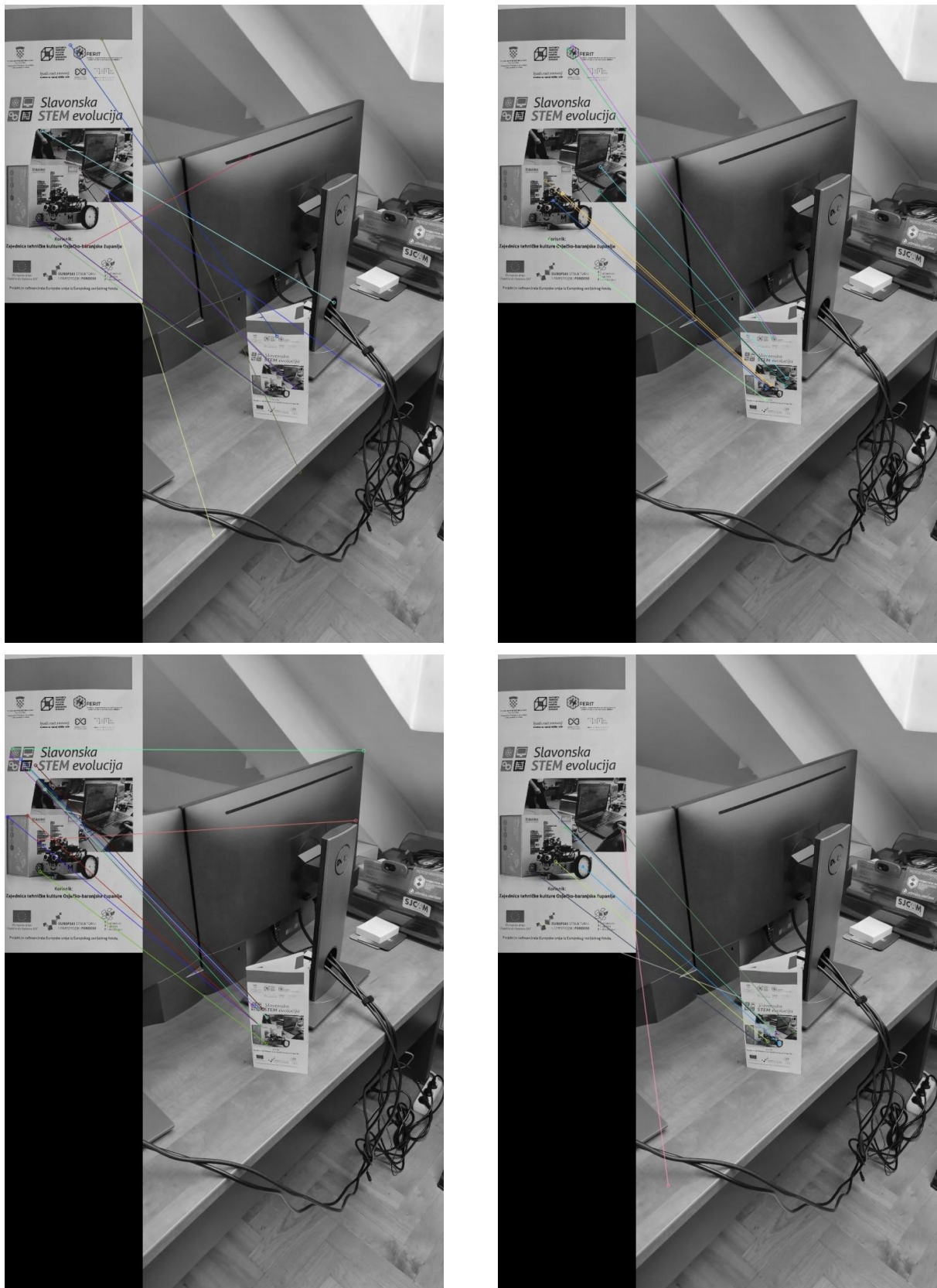
Slika 4.9. Rezultati na slici: gore lijevo FREAK, gore desno BRISK, dolje lijevo SIFT, dolje desno SURF
