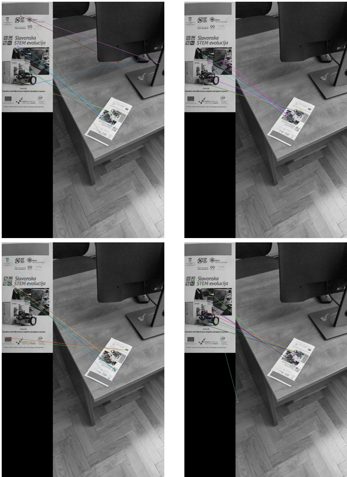
Slika 4.11. Rezultati na slici: gore lijevo FREAK, gore desno BRISK, dolje lijevo SIFT, dolje desno SURF
