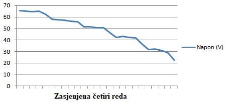
Slika 4.50. Zasjenjena četiri reda modula
