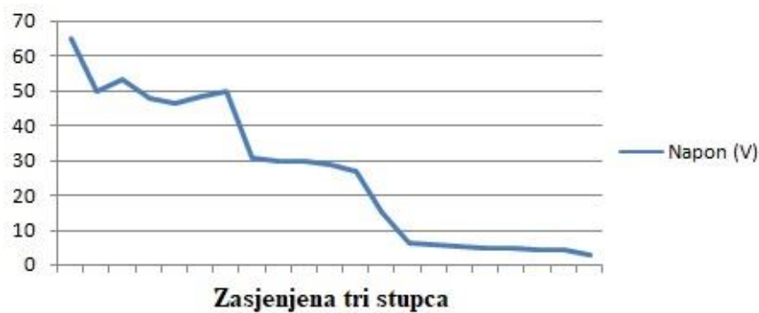
Slika 4.46. Zasjenjena tri stupca modula
