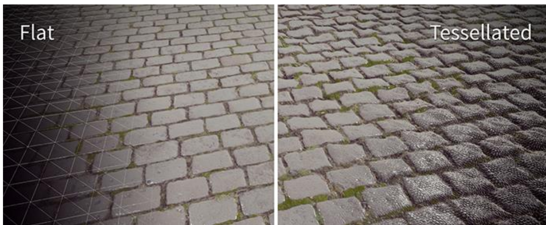
Sl. 2.7. Prikaz teselacijskog shadera na primjeru kaldrme.
