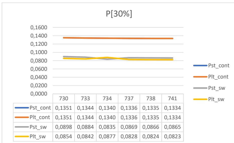
Graf 5.16. Prikaz promjene faktora treperenja na karakterističnim sabirnicama za izlaznu snagu agregata iznosa 30% ukupnog opterećenja
