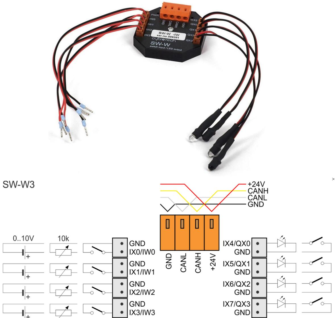
Sl. 4.6. Izgled SW-W3 modula i načelna shema spajanja [7].
