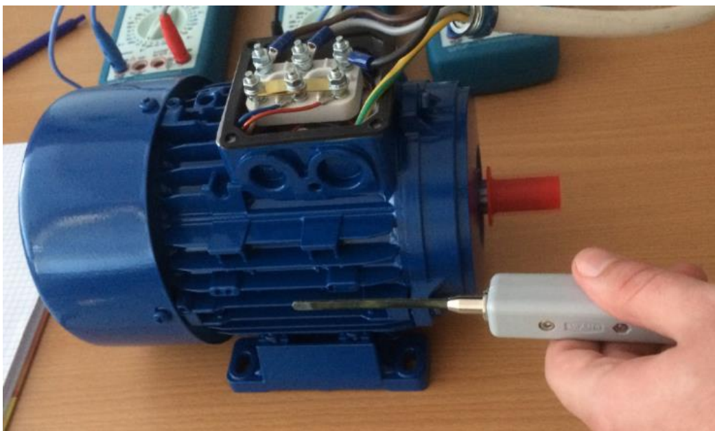
Sl. 4.15. Mjerenje magnetske indukcije izmjeničnog motora
