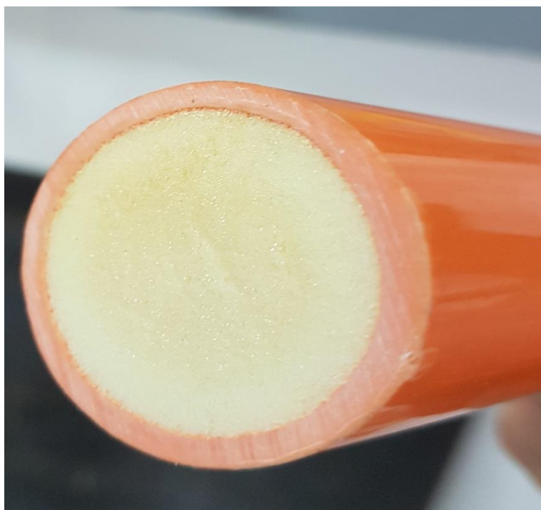
Slika 4.4. Presjek izolacije uzemljivačke motke
