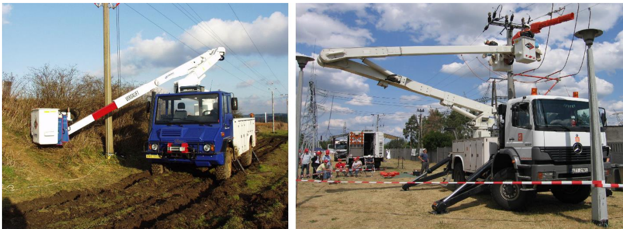
Sl. 3.12. Različite izvedbe hidrauličnih autoplatformi [10,11]
