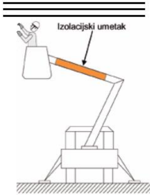
Sl. 3.11. Hidraulička autoplatforma s izolacijskim umetkom [2]
