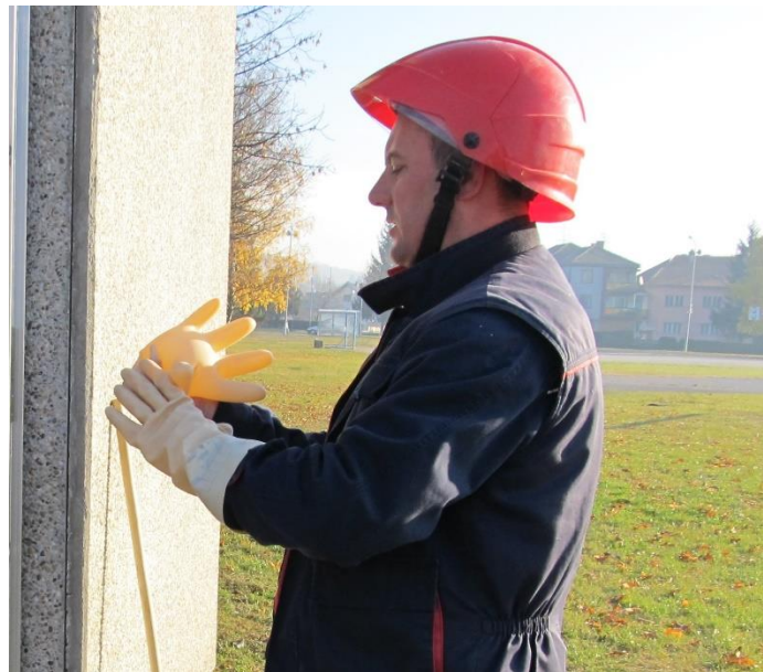
Sl. 3.7. Provjera izolacijskih rukavica napuhivanjem [7]
