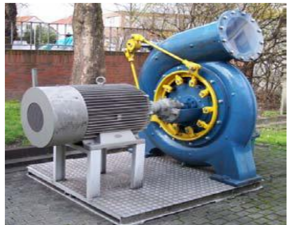
Slika 2.6. Izgled Francisove turbine, [3]
