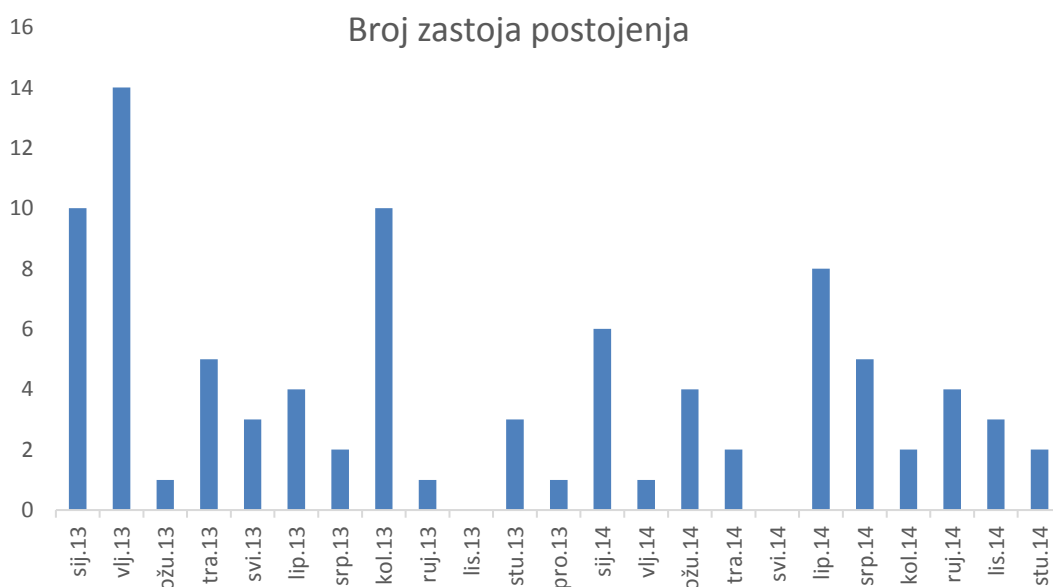
Dijagram 4.2. Ukupan broj zastoja postrojenja nakon izuzimanja zastoja prouzrokovani od strane mreže, redovitim servisima i previsokim vanjskim temperaturama.
