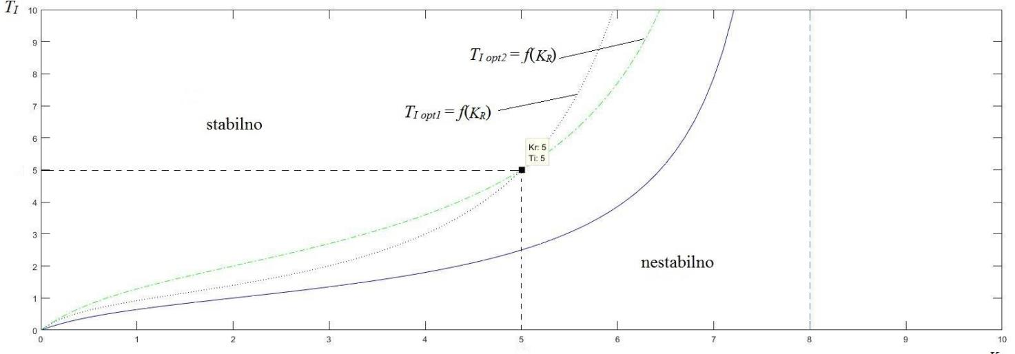
**Slika 3.4.** Dijagram stabilnosti, optimalna točka i optimalne krivulje
