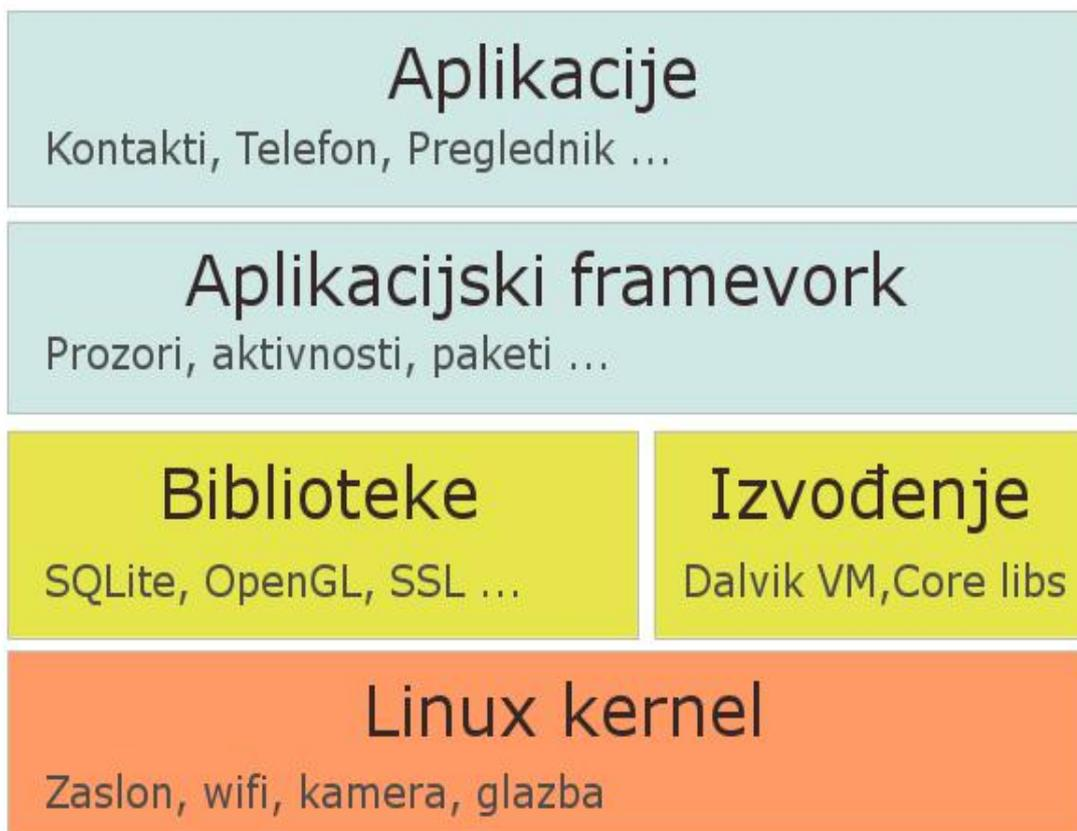
Sl. 3.1. Prikaz građe Android operacijskog sustava. [4]
