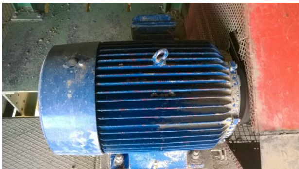
Slika 4.14. Asinkroni motor 1. valjka ispred prese
