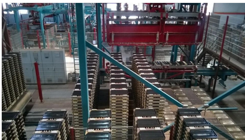
Slika 4.22. Crepovi se pripremaju za pečenje
