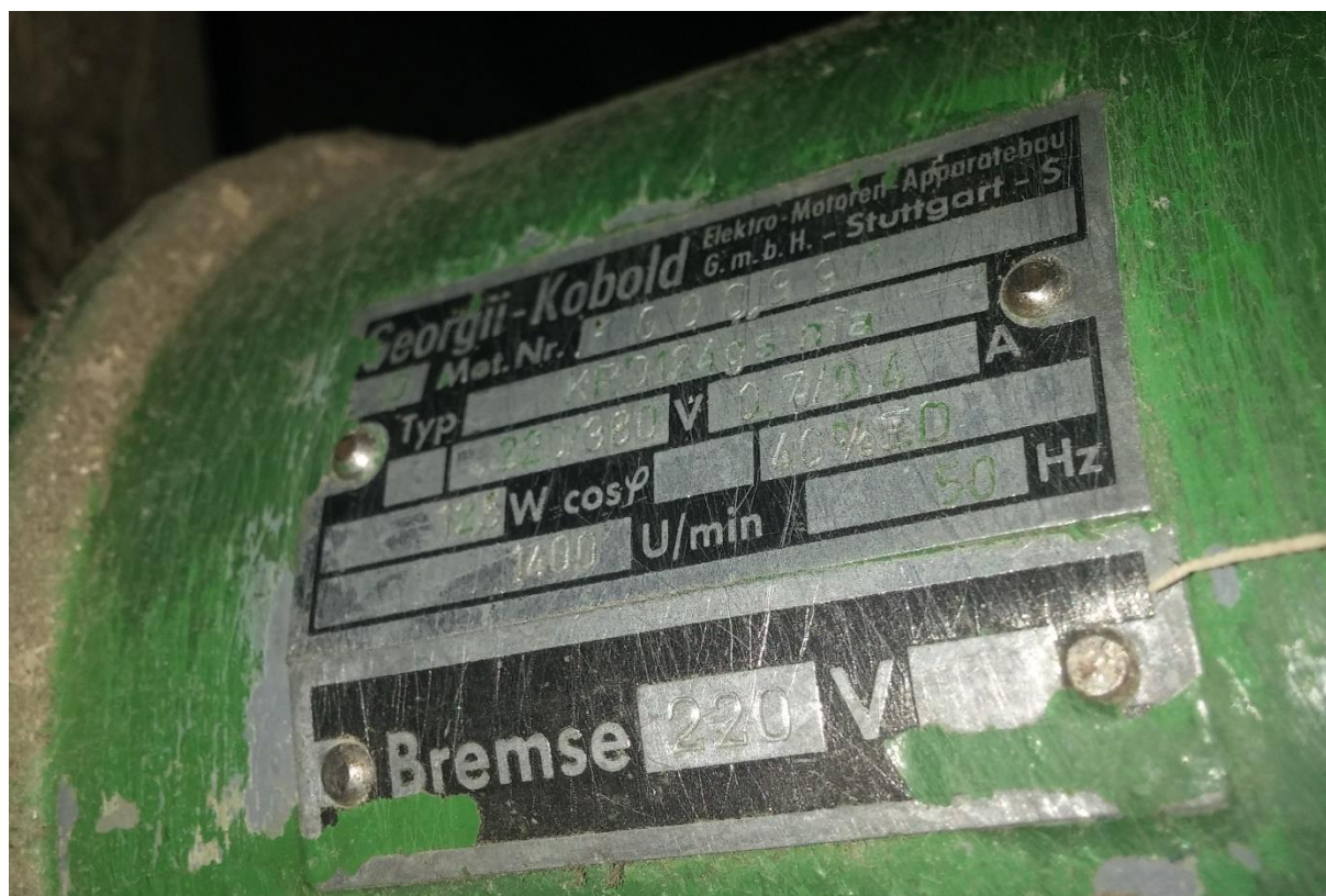
Slika 4.10. Natpisna pločica jednog od motora automatskog slotera
