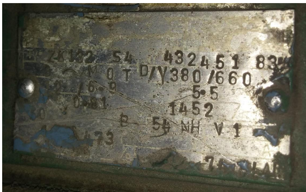
Slika 4.34. Natpisna pločica motora stroja za baliranje
