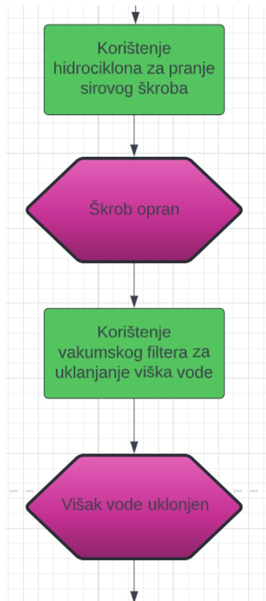
Slika 11 - proces sušenja i uklanjanja viška vode
