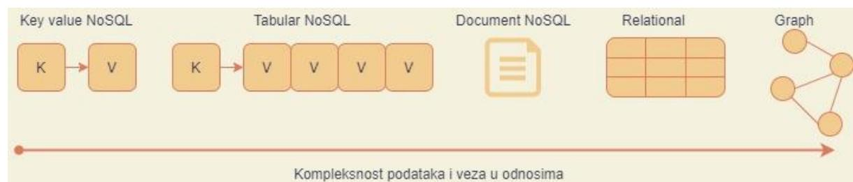
Slika 5 Modeli podataka prema kompleksnosti i povezanosti (The Enlightened DBA, 2014)
