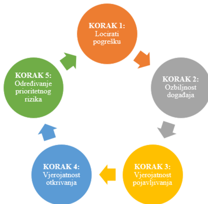
Slika 8 Osnovni princip FMEA metode
