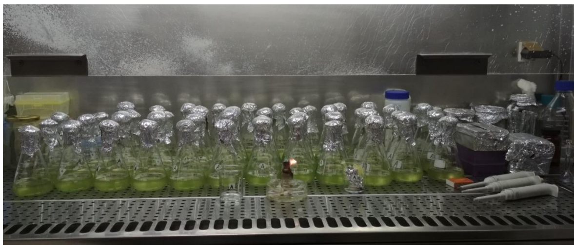
Slika 5. Tretman kulture Monoraphidium cf. contortum provodio se pri sterilnim uvjetima u laminaru (fotografija: Nikolina Sabo).
