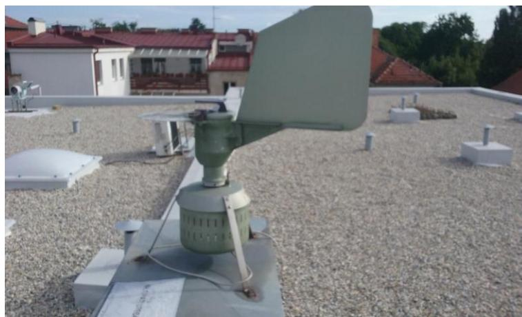
Slika 7: Burkardov volumetrijski aparat
