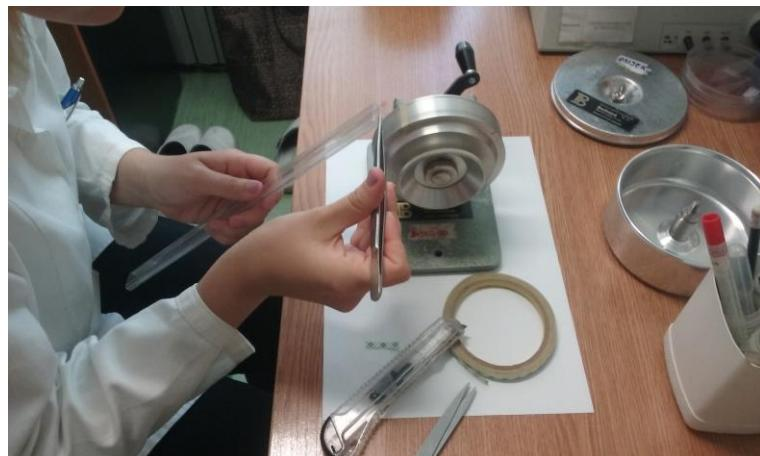
Slika 9: Priprema bubenja s poliesterskom trakom za višednevno uzorkovanje
