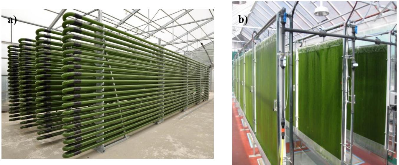
Slika 3. Različiti tipovi zatvorenog fotobiorektora: a) cijevni bioreaktor (Web 23; b) bioreaktor s imobiliziranim stanicama alga (Web 4)
