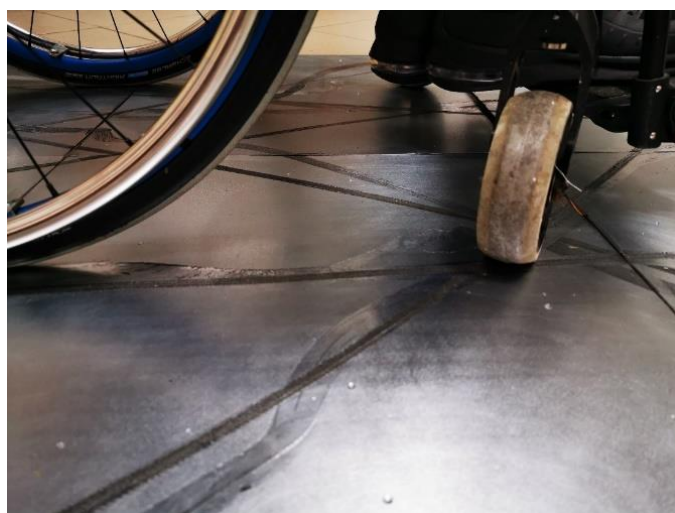
Slika 10. Prikaz procesa rada: prelaženje kolicima preko cinčanih ploča premazanih vazelinom
