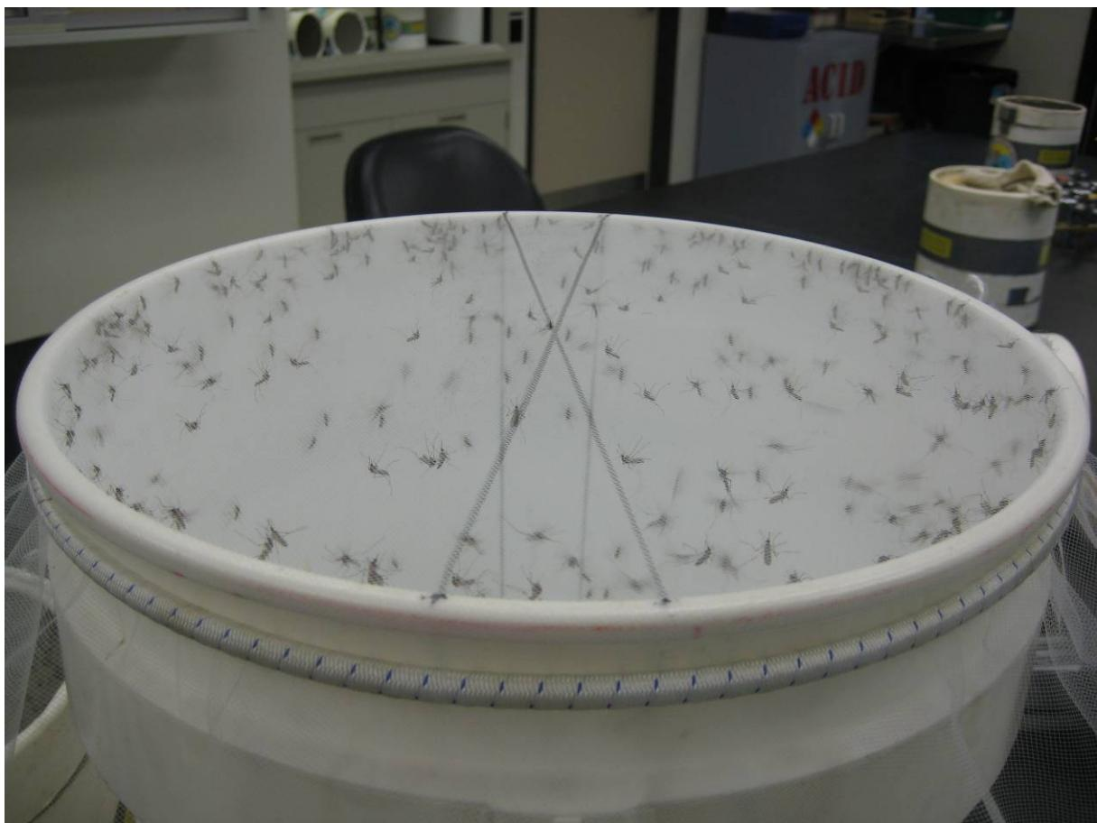
Slika 10. Kanta za primjenu trakaste metode brojenja komaraca
