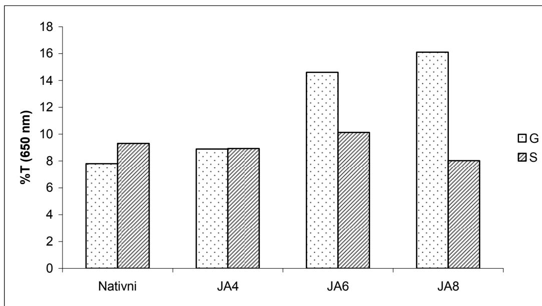
**Slika 61** Bistroća paste (izražena kao % transmitancije pri 650 nm) škroba izoliranog iz pšenice sorte *Golubica* (G) i *Srpanjka* (S) i modificiranog smjesom jantarne kiseline i acetanhidrida (JA) u udjelima 4, 6 i 8 % (w/w)
