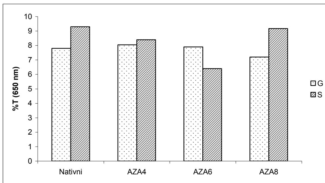
**Slika 88** Bistroća paste (izražena kao % transmitancije pri 650 nm) škroba izoliranog iz pšenice sorte *Golubica* (G) i *Srpanjka* (S) i modificiranog smjesom azelainske kiseline i acetanhidrida (AZA) u udjelima 4, 6 i 8 % (w/w)
