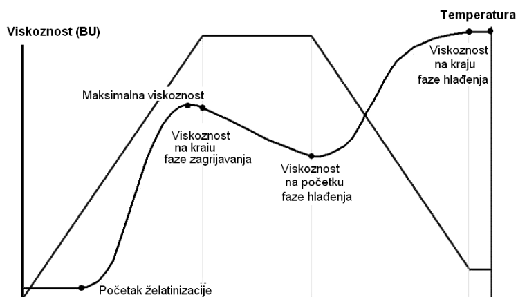
Slika 16 Krivulja promjene viskoznosti otopine uzrokovane otapanjem škroba, mjerene pomoću Brabender-ovog viskoamilografa
