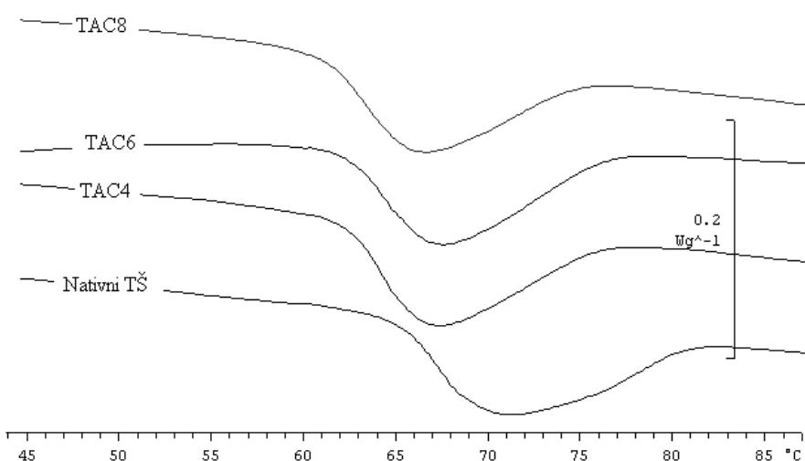
**Slika 13** Krivulje želatinizacije nativnog i modificiranih škrobova tapioke (30 %). TAC4-dodatak 4 %, TAC6-dodatak 6 % i TAC8-dodatak 8 % acetanhidrida na s. tv. škroba tijekom modificiranja (Babić, 2007).
