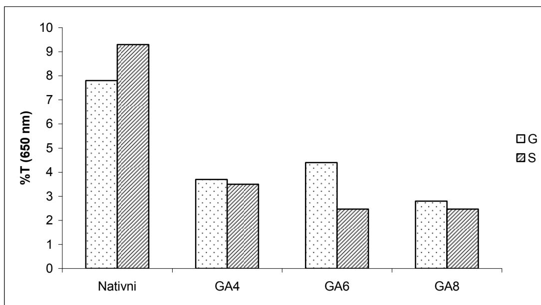
**Slika 70** Bistroća paste (izražena kao % transmitancije pri 650 nm) škroba izoliranog iz pšenice sorte *Golubica* (G) i *Srpanjka* (S) i modificiranog smjesom glutarne kiseline i acetanhidrida (GA) u udjelima 4, 6 i 8 % (w/w)
