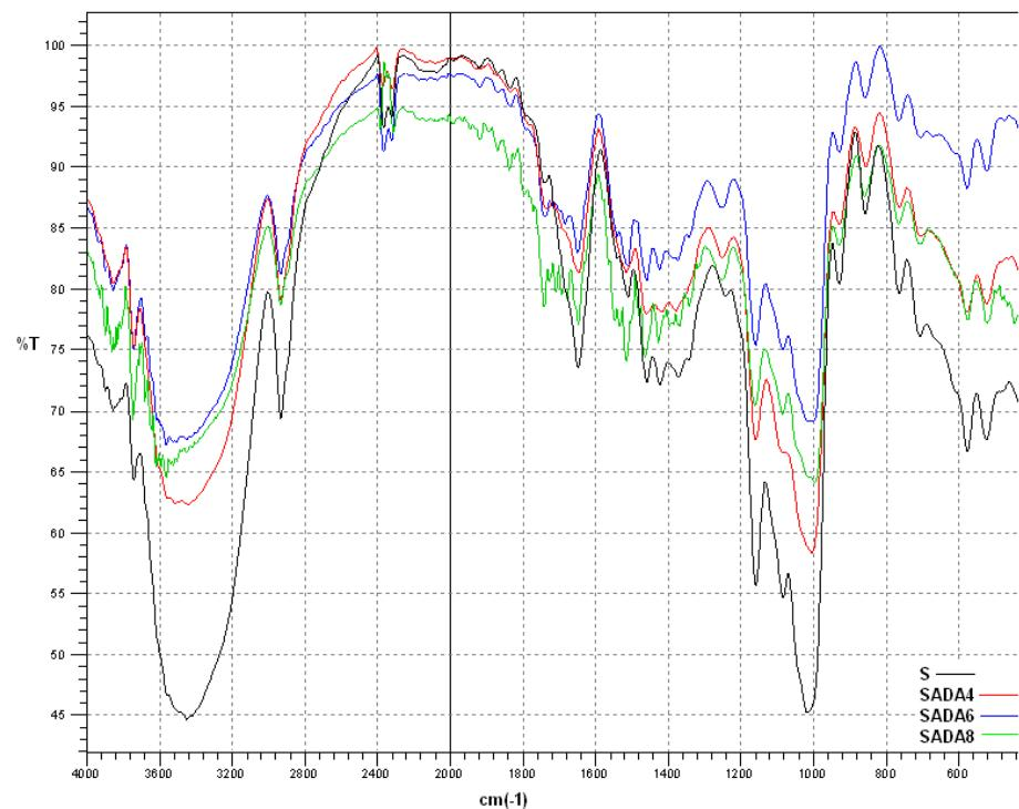
**Slika 73** IR-spektar škroba izoliranog iz pšenice sorte *Srpanjka* i modificiranog smjesom adipinske kiseline i acetanhidrida (ADA) u udjelima 4, 6 i 8 % (w/w)
