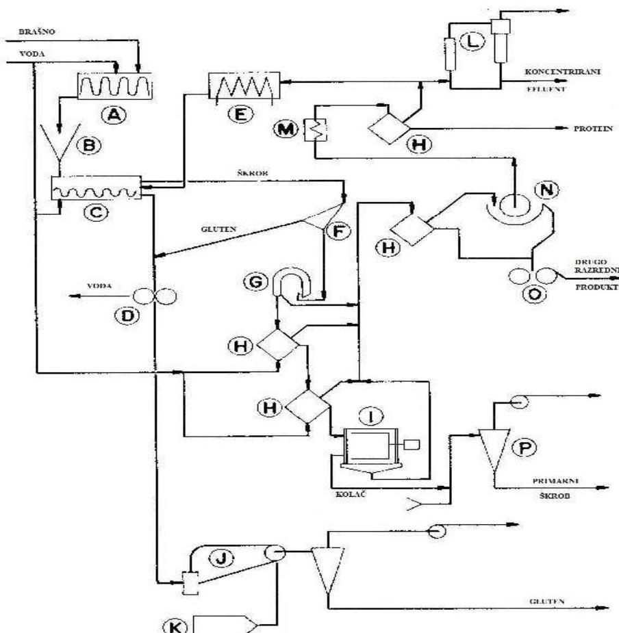
**Slika 4** Martinov proces: A) miješalica, B) lijevak za punjenje, C) ekstraktor, D) valjci, E) pločasti izmjenjivač topline, F) sito, G) rešeto, H) centrifuga, I) kružna centrifuga, J) sušnica, K) grijач, L) uparivač, M) cijevni izmjenjivač topline, N) filter, O) valjci, P) sušnica (Knight i Olson, 1984)
