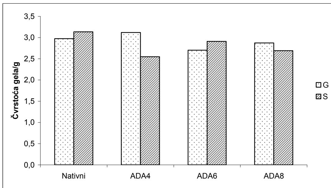
**Slika 74** Čvrstoća gelova (11 % s. tv.) škroba izoliranog iz pšenice sorte *Golubica* (G) i *Srpanjka* (S) i modificiranog smjesom adipinske kiseline i acetanhidrida (ADA) u udjelima 4, 6 i 8 % (w/w)
