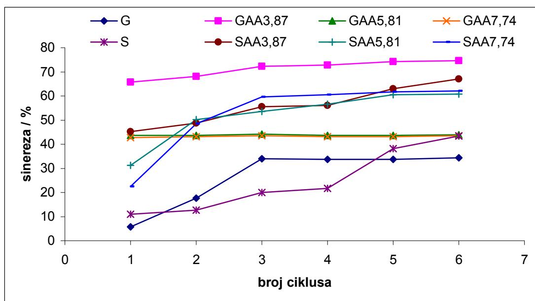
**Slika 53** Stabilnost u ciklusima zamrzavanje – odmrzavanje (-18 °C, 22 h/30 °C 2 h), izražena kao % sinereze, škroba izoliranog iz pšenice sorte *Golubica* (G) i *Srpanjka* (S) i modificiranog acetanhidridom (A) u udjelima 3,87; 5,81 i 7,74 % (w/w)
