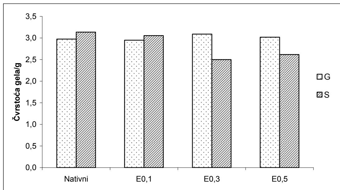
**Slika 38** Čvrstoća gelova (11 % s.t.v.) škroba izoliranog iz pšenice sorte *Golubica* (G) i *Srpanjka* (S) i modificiranog epiklorhidrinom (E) u udjelima 0,1; 0,3 i 0,5 % (v/w)
