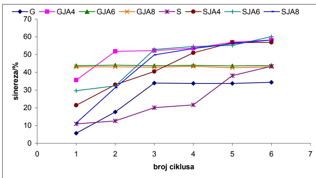
**Slika 62** Stabilnost u ciklusima zamrzavanje – odmrzavanje (-18 °C, 22 h/30 °C 2 h), izražena kao % sinereze, škroba izoliranog iz pšenice sorte *Golubica* (G) i *Srpanjka* (S) i modificiranog smjesom jantarne kiseline i acetanhidrida (JA) u udjelima 4, 6 i 8 % (w/w)
