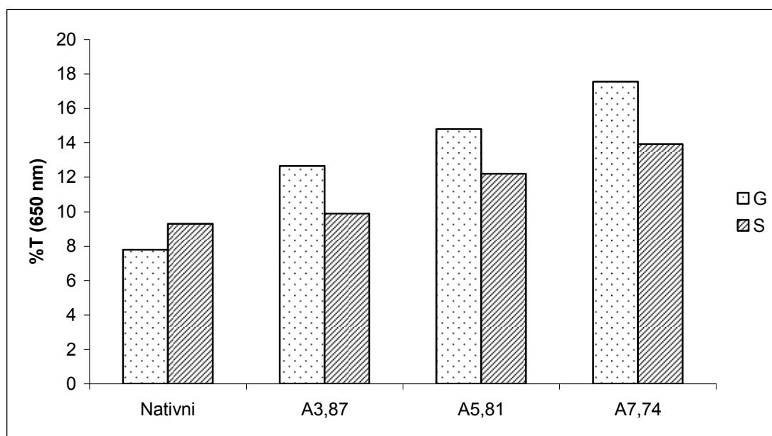
**Slika 52** Bistroća paste (izražena kao % transmitancije pri 650 nm) škroba izoliranog iz pšenice sorte *Golubica* (G) i *Srpanjka* (S) i modificiranog acetanhidridom (A) u udjelima 3,87; 5,81 i 7,74 % (w/w)
