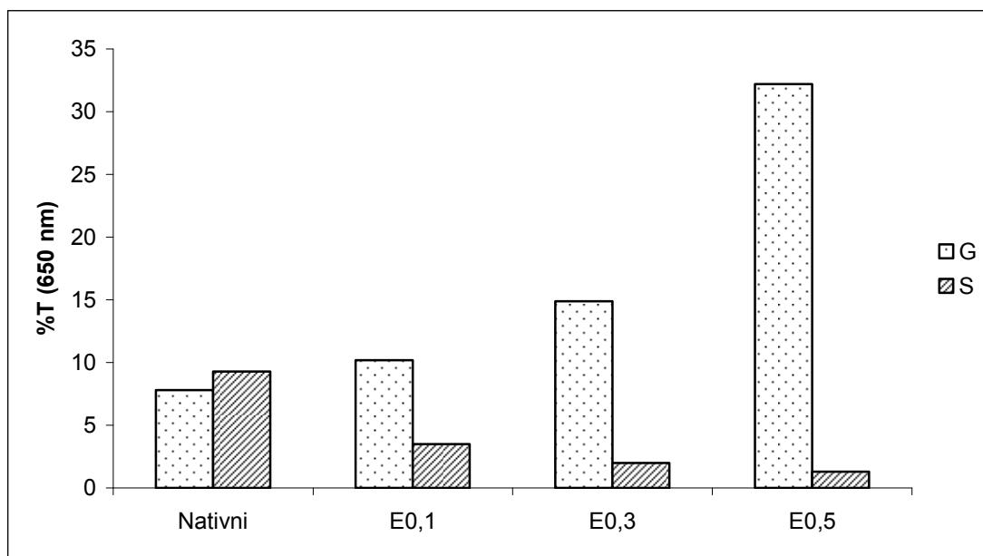
**Slika 43** Bistroća paste (izražena kao % transmitancije pri 650 nm) škroba izoliranog iz pšenice sorte *Golubica* (G) i *Srpanjka* (S) i modificiranog epiklorhidrinom (E) u udjelima 0,1; 0,3 i 0,5 % (v/w)
