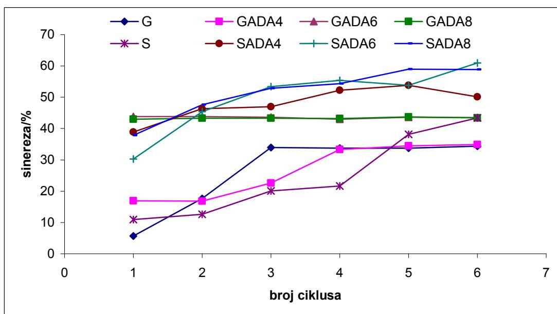
**Slika 80** Stabilnost u ciklusima zamrzavanje – odmrzavanje (-18 °C, 22 h/30 °C 2 h), izražena kao % sinereze, škroba izoliranog iz pšenice sorte *Golubica* (G) i *Srpanjka* (S) i modificiranog smjesom adipinske kiseline i acetanhidrida (ADA) u udjelima 4, 6 i 8 % (w/w)
