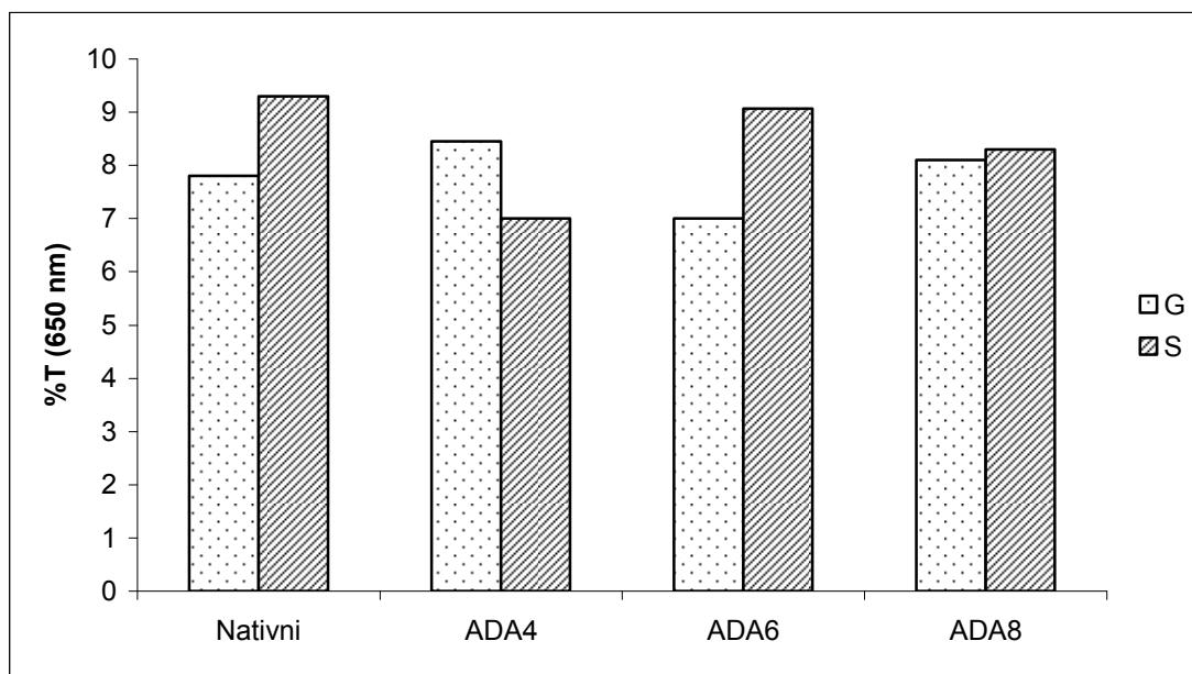
**Slika 79** Bistroća paste (izražena kao % transmitancije pri 650 nm) škroba izoliranog iz pšenice sorte *Golubica* (G) i *Srpanjka* (S) i modificiranog smjesom adipinske kiseline i acetanhidrida (ADA) u udjelima 4, 6 i 8 % (w/w)
