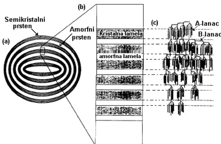
**Slika 11** Shematski prikaz strukture škrobne granule; (a), koncentrični prstenovi koji izgrađuju škrobnu granulu, svaki prsten sadrži kristalne i amorfne lamele; (b), amorfne i kristalne lamele; (c), položaj lanaca molekule amilopektina u granuli
