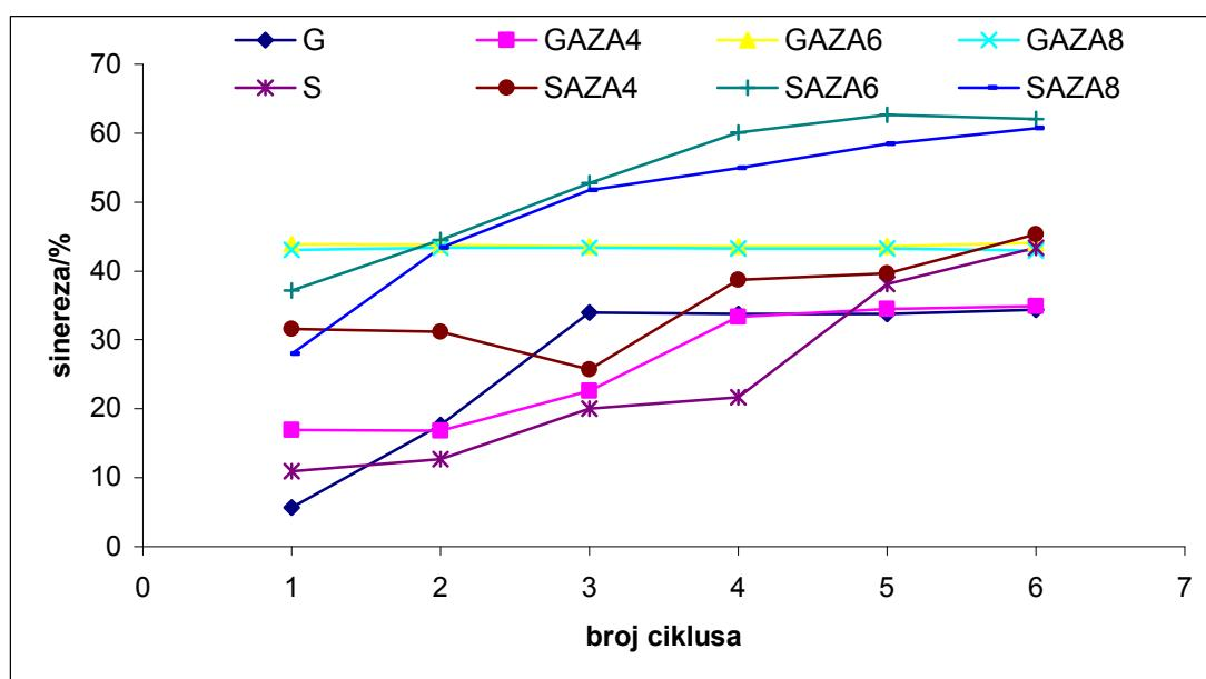
**Slika 89** Stabilnost u ciklusima zamrzavanje – odmrzavanje (-18 °C, 22 h/30 °C 2 h), izražena kao % sinereze, škroba izoliranog iz pšenice sorte *Golubica* (G) i *Srpanjka* (S) i modificiranog smjesom azelainske kiseline i acetanhidrida (AZA) u udjelima 4, 6 i 8 % (w/w)
