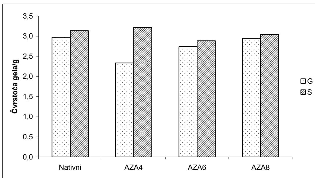
**Slika 83** Čvrstoća gelova (11 % s. tv.) škroba izoliranog iz pšenice sorte *Golubica* (G) i *Srpanjka* (S) i modificiranog smjesom azelainske kiseline i acetanhidrida (AZA) u udjelima 4, 6 i 8 % (w/w)
