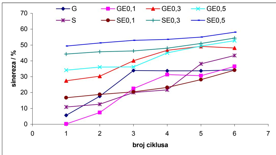
**Slika 44** Stabilnost u ciklusima zamrzavanje – odmrzavanje (-18 °C, 22 h/30 °C 2 h), izražena kao % sinereze, škroba izoliranog iz pšenice sorte *Golubica* (G) i *Srpanjka* (S) i modificiranog epiklorhidrinom (E) u udjelima 0,1; 0,3 i 0,5 % (v/w)
