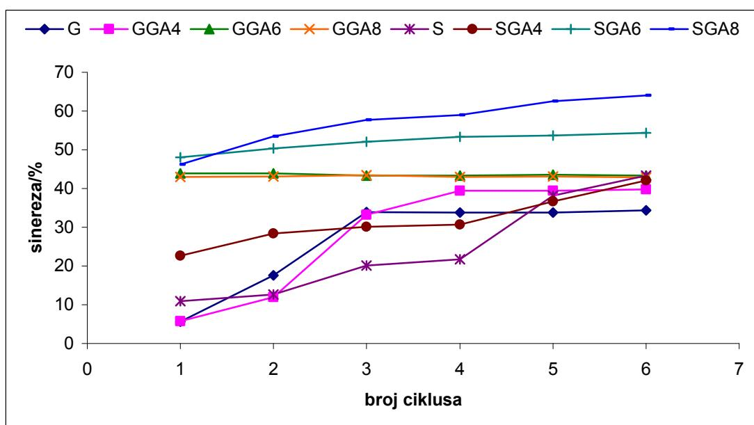
**Slika 71** Stabilnost u ciklusima zamrzavanje – odmrzavanje (-18 °C, 22 h/30 °C 2 h), izražena kao % sinereze, škroba izoliranog iz pšenice sorte *Golubica* (G) i *Srpanjka* (S) i modificiranog smjesom glutarne kiseline i acetanhidrida (GA) u udjelima 4, 6 i 8 % (w/w)
