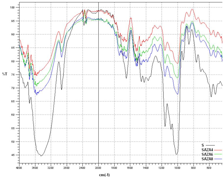
**Slika 82** IR-spektar škroba izoliranog iz pšenice sorte *Srpanjka* (S) i modificiranog smjesom azelainske kiseline i acetanhidrida (AZA) u udjelima 4, 6 i 8 % (w/w)
