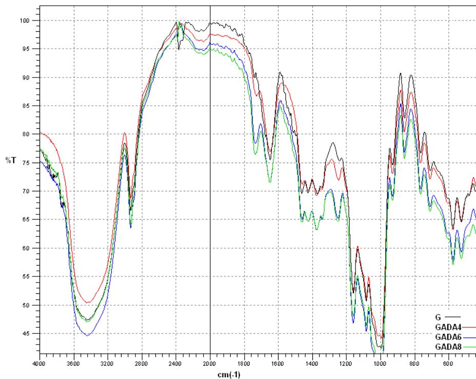
**Slika 72** IR-spektar škroba izoliranog iz pšenice sorte *Golubica* i modificiranog smjesom adipinske kiseline i acetanhidrida (ADA) u udjelima 4, 6 i 8 % (w/w)
