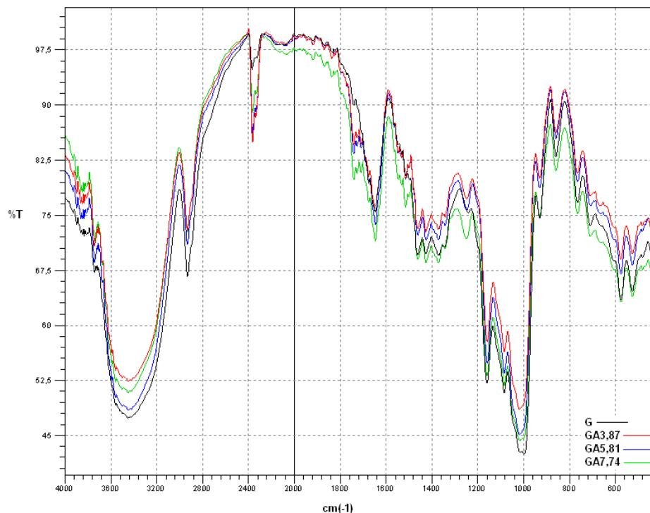
**Slika 45** IR-spektar škroba izoliranog iz pšenice sorte *Golubica* (G) i modificiranog acetanhidridom (A) u udjelima 3,87; 5,81 i 7,74 % (w/w)
