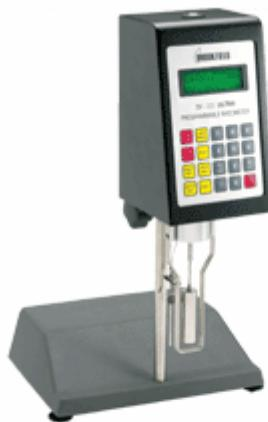
Slika 42. Rotacijski viskozimetar DV III+ Brookfield.
