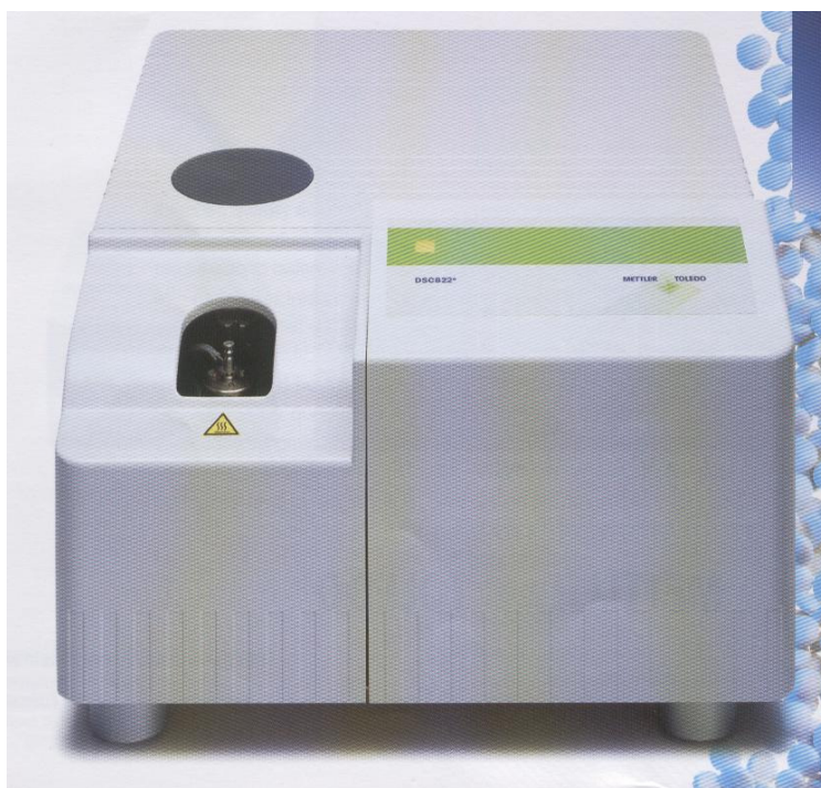
Slika 40. Diferencijalni motridbeni kalorimetar tip DSC 822 e .
