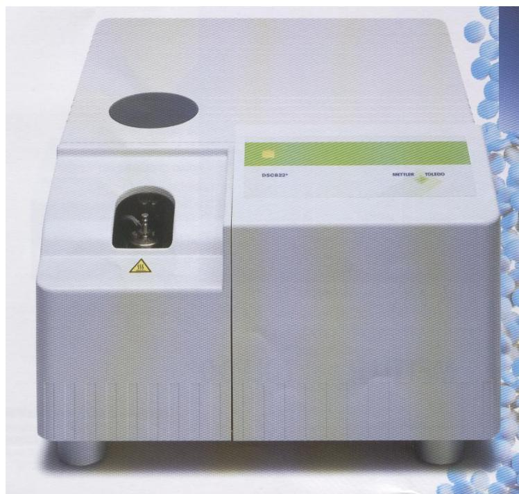
Slika 40. Diferencijalni motridbeni kalorimetar tip *DSC 822<sup>e</sup>*.
