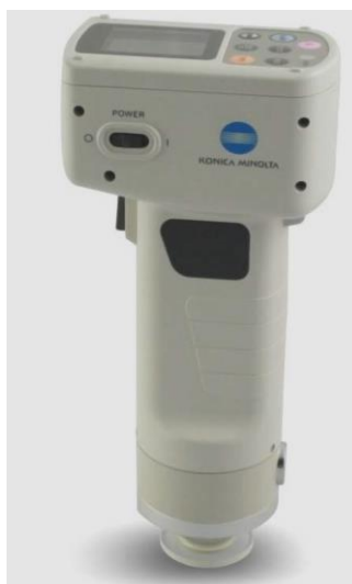
Slika 8 Kromametar Konica Minolta CR-300 (Tanasković, 2014)
