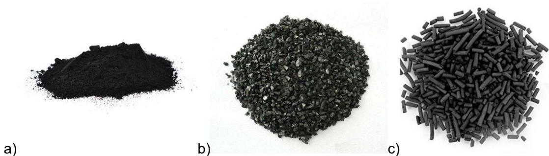
**Slika 5** Aktivni ugljen u praškastom (a), granuliranom (b) i peletnom obliku (c)
