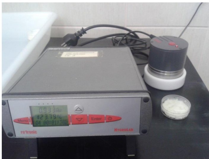
Slika 16 HygroLab 3 (uređaj za određivanje aktiviteta vode)
