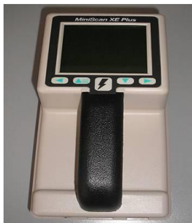
Slika 11 Kolorimetar Hunter-Lab Mini ScanXE
