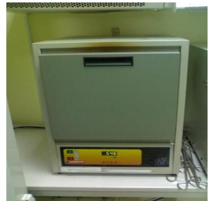
Slika 8 Žarenje u mufolnoj peći
