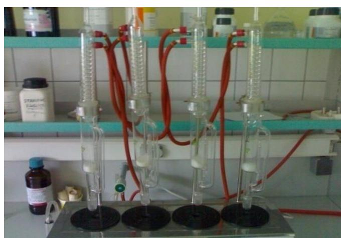
**Slika 9** Aparatura za ekstrakciju masti po Soxhletu (Jozinović, 2011.)
