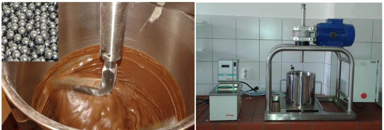
Slika 17 Kuglični mlin
