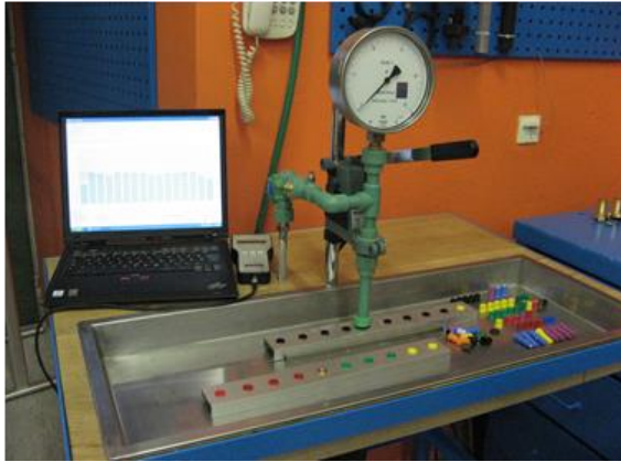
Slika 19. Stolno – elektronski uređaj za mjerenje protoka mlaznica (lijevo) i uređaj za mjerenje protoka AAMS (desno)
