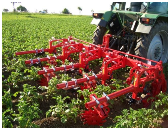
Slika 7. Mehaničko suzbijanje korova u krumpiru (Foto:OPG Mžik)
