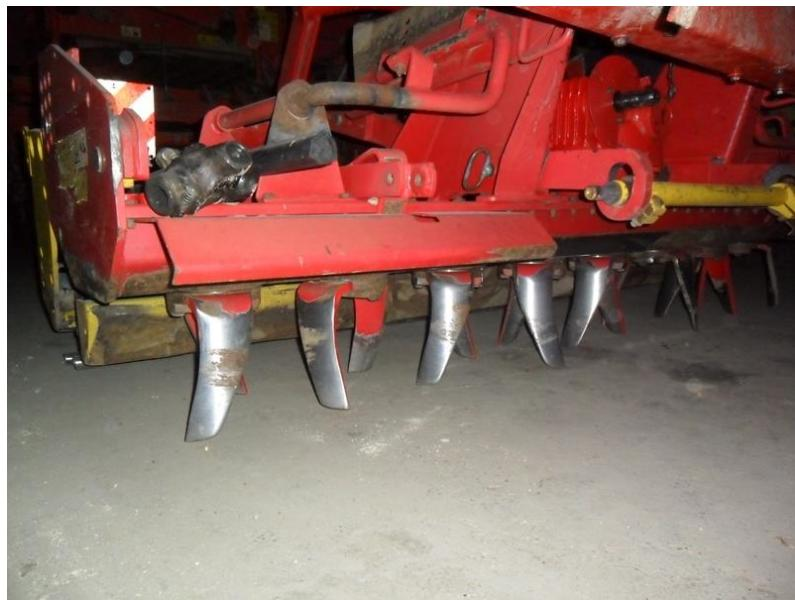
Slika 10. Zupci na rotodrljači ( Foto: Anja Kolarić )
