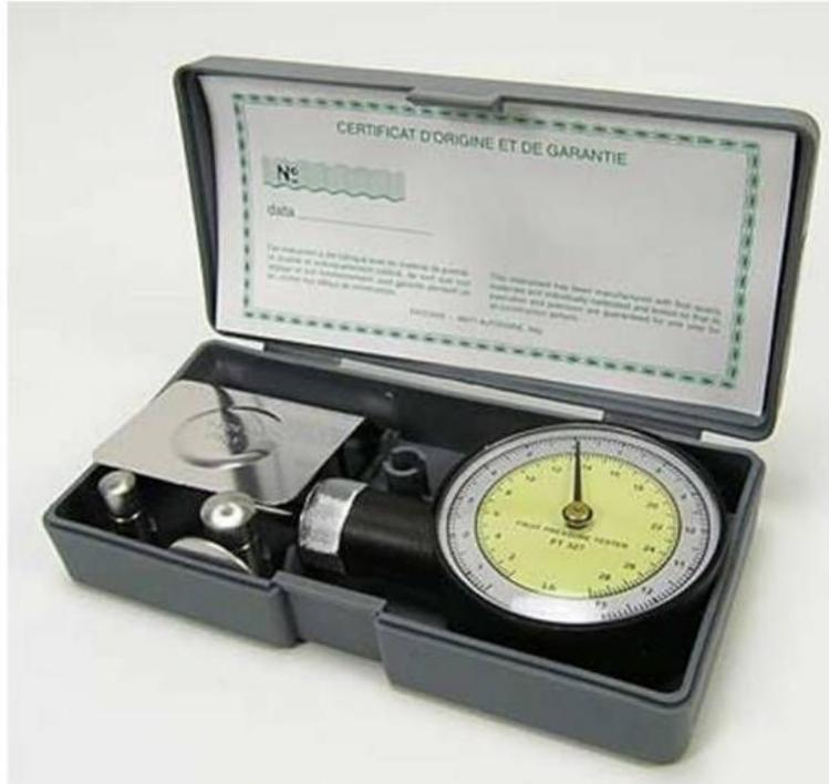
Slika 4. Penetrometar za mjerenje tvrdoće ploda ([www.agrologistika.hr](http://www.agrologistika.hr))
