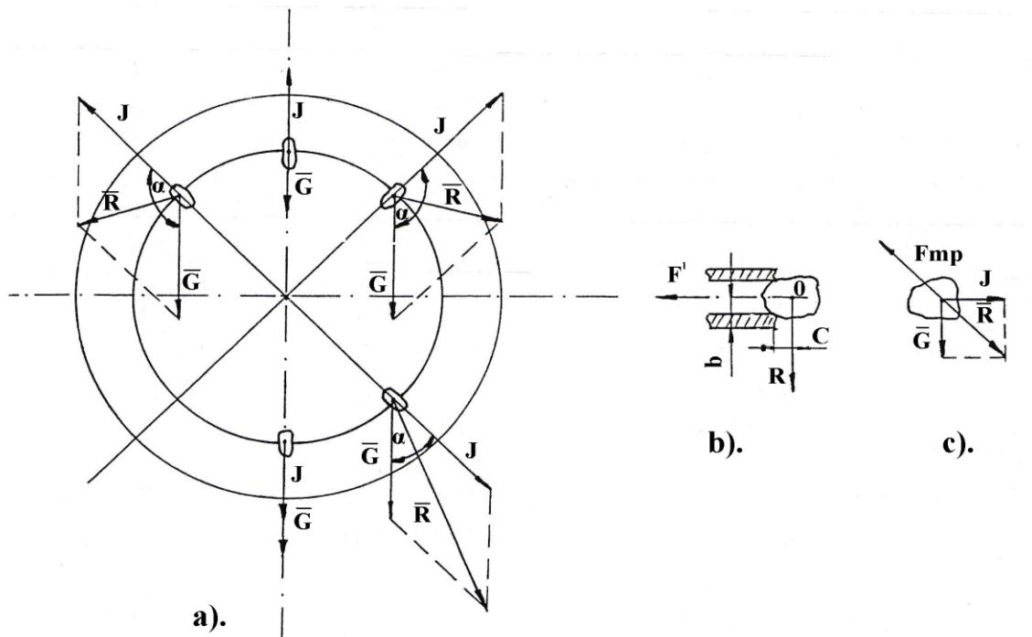
Slika 21. Shematski prikaz sila koje djeluju na zrno. A) Djelovanje sile na zrno u ovisnosti od položaja usisnog otvora. B) Sile na usisnom otvoru. C) Projekcija sila na pravac rezultante.
